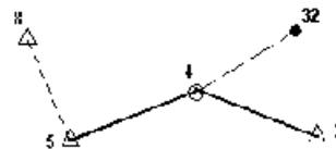
Como desde ninguna de ellas se ve el punto 32, realizamos una poligonal encuadrada entre 5 y 3 orientando en 8 y creando la estación intermedia 4 según el croquis adjunto. Desde la estación 4 se podrá replantear el punto 32. Los datos observados en la poligonal son:
